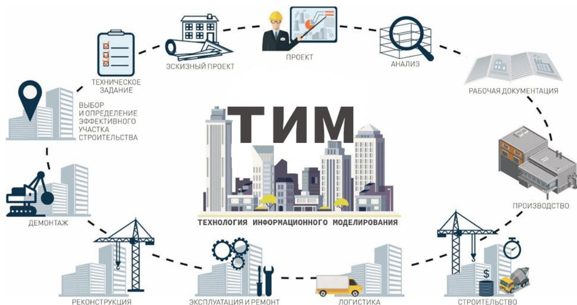
Рис.1. Жизненный цикл строительного объекта в BIM-технологии
